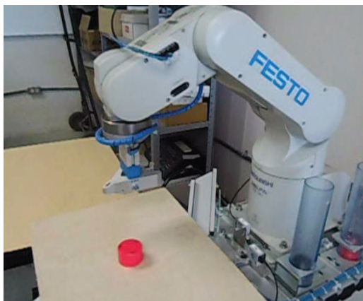
Figura 5: Robot RV-2AJ Mitsubishi a manipular una pieza roja con su gripper.
