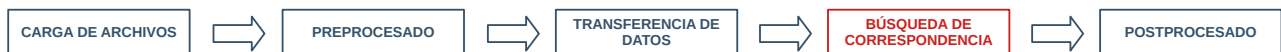
Figura 3.2: Diagrama general de la metodología propuesta. El proceso marcado con rojo es el implementado en el FPGA, mientras que en azul es la parte que está en el microcontrolador.
