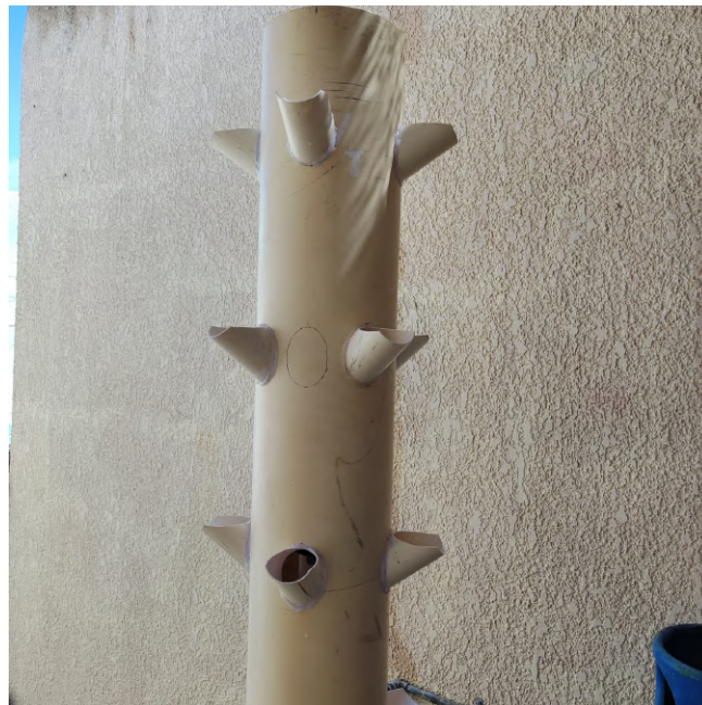
Figura 2.5: Tubo para sistema de cultivo aerónico en vertical.
