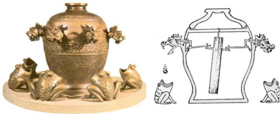
Figura 2.6.2 Primer sismoscopio inventado por el científico chino Heng Chen (Año 132 d.C.)
