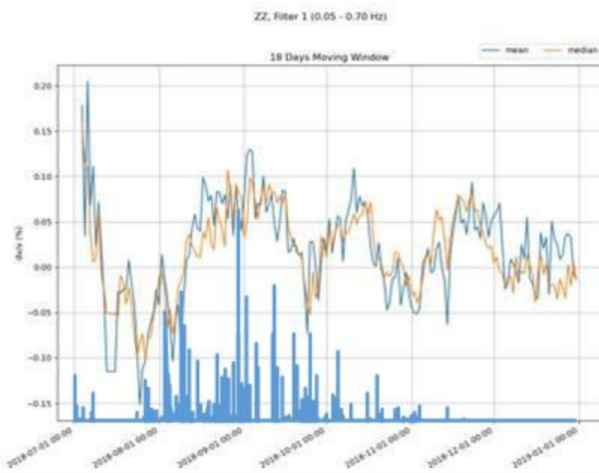
Figura 4.1.1 Series de tiempo de dv/v para la cuenca del Valle de México y valores de precipitación de la estación CU (2018) [19].
